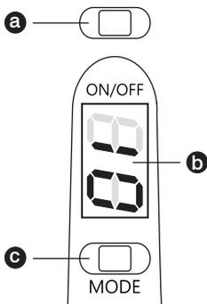
**a** ON-OFF : Mit der Betätigung dieses Schalters wird automatisch die Gewählte Funktion durchgeführt. Eine erneute Betätigung unterbricht sofort die aktuell ausgewählte Belichtungsart. Wenn sich das Gerät im „Sleep“-Modus befindet, wechselt es bei der Betätigung sofort in den zuletzt gewählten Belichtungsmodus.
