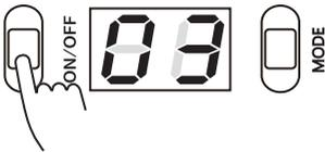
Die Belichtung kann durch erneutes Drücken des ON/OFF Knopfes unterbrochen werden. Die Zeit der Bestrahlung wird dann automatisch zurückgesetzt.
