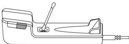
Stellen Sie sicher, dass der Radiometersensor frei von Fremdkörpern ist, die die Messgenauigkeit beeinträchtigen könnten.
