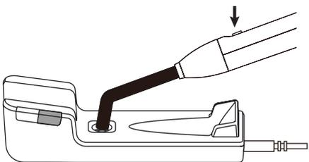
Testen Sie den Lichtleiter mit der integrierten Intensitätsanzeige.
